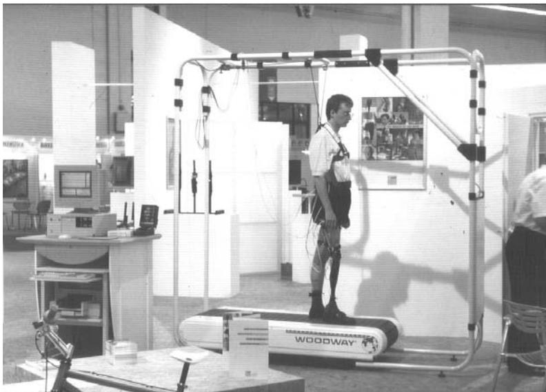
*(Kombination von Laufband mit PC-Interface, Ultraschall-3D-Ganganalyse in Echtzeit und elektronisch verstellbarer Prothese mit PC-Interface)*
