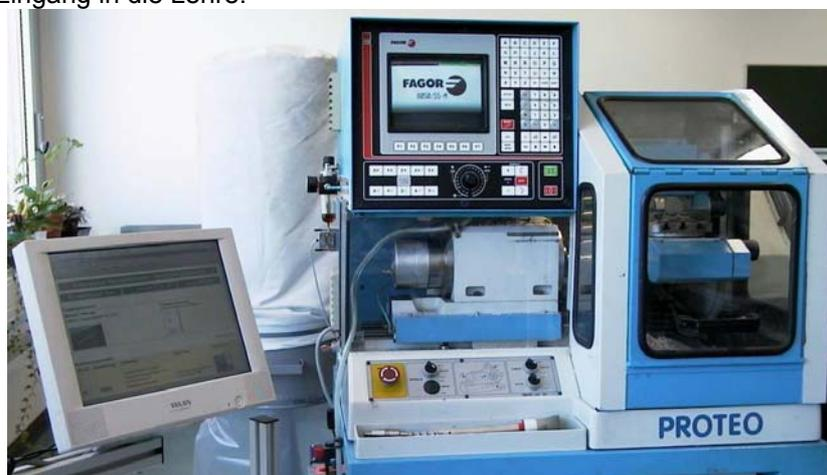
Abb. 4: Einsatz eines multimedialen Einstell- und Arbeitsplanes für die Teilefertigung (Versuchsstand)
