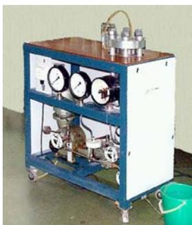
wird über den 50/50-Koppler in das FBG, das sich in einer Druckkammer befindet, eingekoppelt. Von dem reflektierten Licht mit der Bragg-Wellenlänge  $\lambda_{\text{Bragg}}$  gelangen 50% über den Koppler an den optischen Spektralanalysator OSA zur Auswertung. Das offene Gitterende wird reflexionsfrei abgeschlossen. Der optische Spektralanalysator hat eine maximale Auflösung von 0,007 nm.
