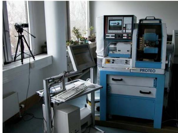
Bild 3.2: Konzeption und Aufbau des Versuchsstandes zur multimedial gestützten Fertigung an einer NC-Fräsmaschine in der Trainingsfabrik
