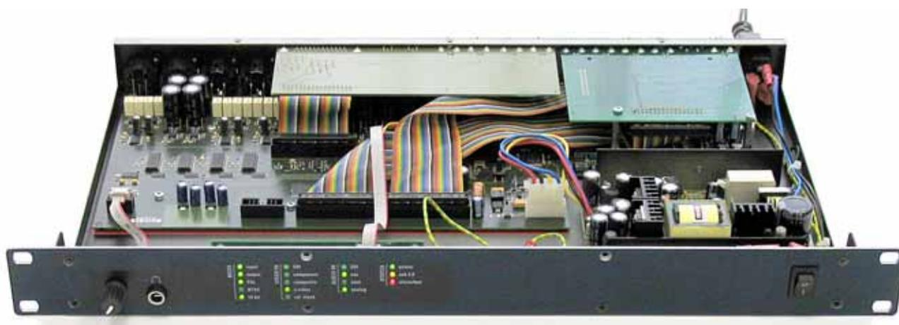
Abb. 3: Prototyp des entwickelten A/V-Formatconverters mit den von der Hochschule entwickelten Baugruppen VMO und VMI
