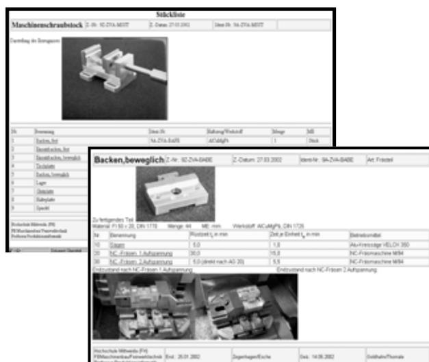
Bild 6: Beispiel-Regel zur Wissensstruktur und Ausschnitt multimediales Arbeitsmittel: Stückliste und Arbeitsplan für Schraubstock
