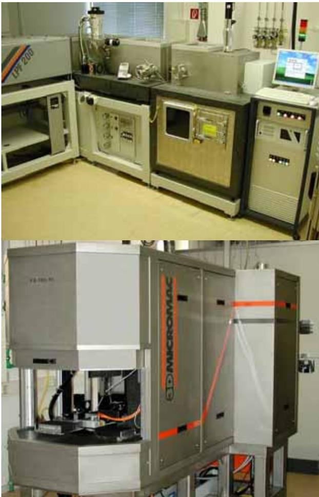
Bild 1: Im Laserinstitut vorhandene Lasermikrobearbeitungsanlagen mit fs-Laser (unten) und F<sub>2</sub>-Laser (oben).
