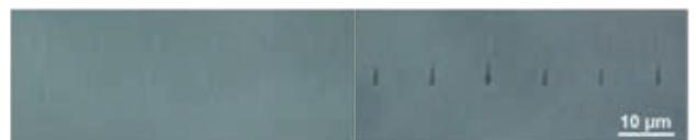
Abb. 2: Bearbeitungsergebnis mit Brennweite 4mm, Seitenansicht der erzeugten Defekte mit Einzelpulsen in BK7 (links) und Fused Silica (rechts). Einstrahlrichtung der Laserstrahlung von unten nach oben. Pulsenergien / Spitzenintensitäten von links nach rechts: 350 – 400 nJ in 10 nJ – Schritten / 76 – 86  $\text{TW/cm}^2$
