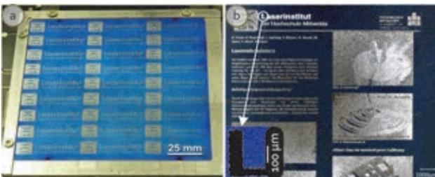
Abb 9: Entschichten ( $\text{Si}_3\text{N}_4$ ) eines  $6''$ -Silizium-Wafers (Linien:  $30 \text{ }\mu\text{m}$ ,  $P_{cw}$ :  $400 \text{ W}$ ,  $v$ :  $200 \text{ ms}^{-1}$ ,  $w_{86}$ :  $40 \text{ }\mu\text{m}$ ) (a): Prozeßzeit:  $20 \text{ s}$  (b): Auflösungstest: „DIN A4“ auf  $10 \text{ mm}$ .
