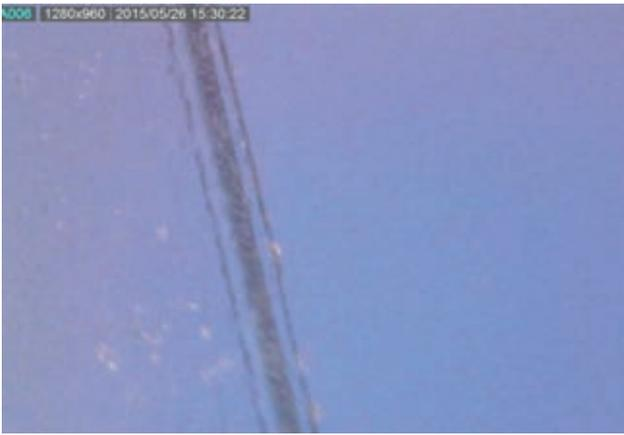
Bild 6: Schnittkante Kalk-Natron- Glasfolie 200µm dick
