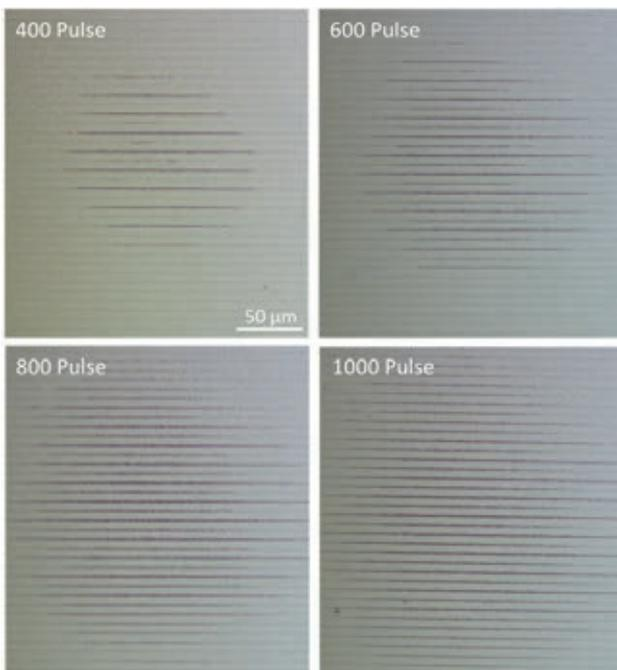
Abb. 12: Mikroskopaufnahmen von Materialveränderungen des Nanometerschichtstapels durch das eingestrahlte Interferenzmuster bei maximal möglicher Pulsenergie
