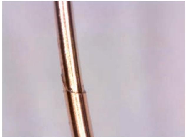
Bild 8: Laserablation von PU- Isolierung von dünnem Cu- Draht
