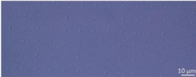
Abb. 9: Bild im Polarisationsmikroskop von durch Einzelpulse der Pulsenergie 300 nJ (Intensität  $132 \text{ TW/cm}^2$ ) mit 100x Immersionsobjektiv generierten Mikrohöhlräumen
