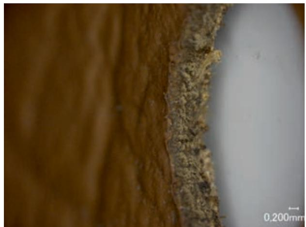
Bild 9: Schnittkante einer Bohrung in Leder
