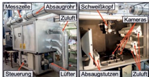
Bild 1: Anlagenmodell mit Zuluft- und Abluftsystemen sowie Mess- und Kamertechnik
