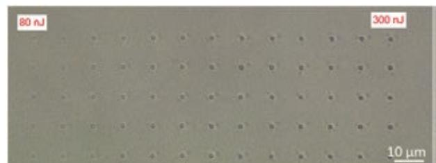
Abb. 7: Einzelpulse verschiedener Pulsenergien/ Spitzenintensitäten (80 - 300 nJ in 20 nJ Schritten / 35 - 132 TW/cm<sup>2</sup> in 8,8 TW/cm<sup>2</sup>-Schritten) mit 100x Immersionsobjektiv (Brennweite 2 mm)
