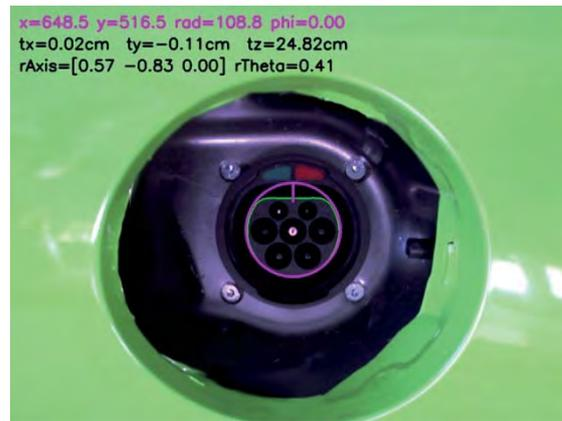
Abbildung 2: 2D-Steckerdetektion und 3D-Lageschätzung
