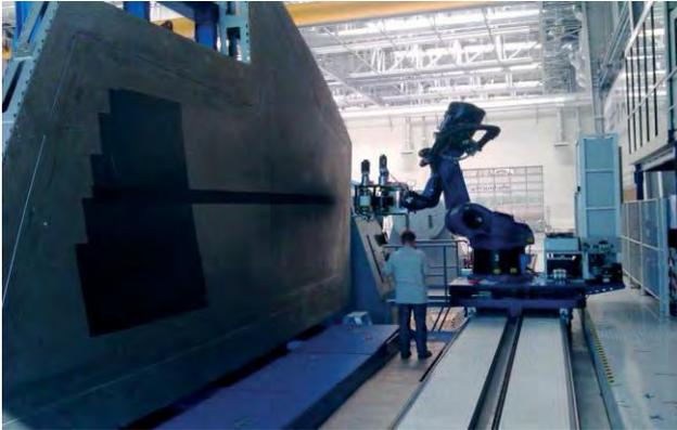
Bild 4: Applikation zur Bearbeitung langer Flugzeugbauteile
