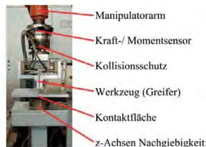
Bild 2: Versuchsstand zur Kraftregelung
