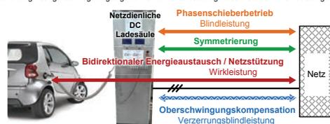
Folgende Funktionen können am Prototyp der netzdienlichen Ladesäule entwickelt werden:
