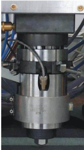
Die Scheibenplastifizierung ist eine Kombination von Schneckensegment und Scheibe. Das Granulat wird durch das Schneckensegment dosiert, vorgewärmt, entgast und zwischen rotierender Scheibe sowie beheiztem Stator plastifiziert und homogenisiert.
