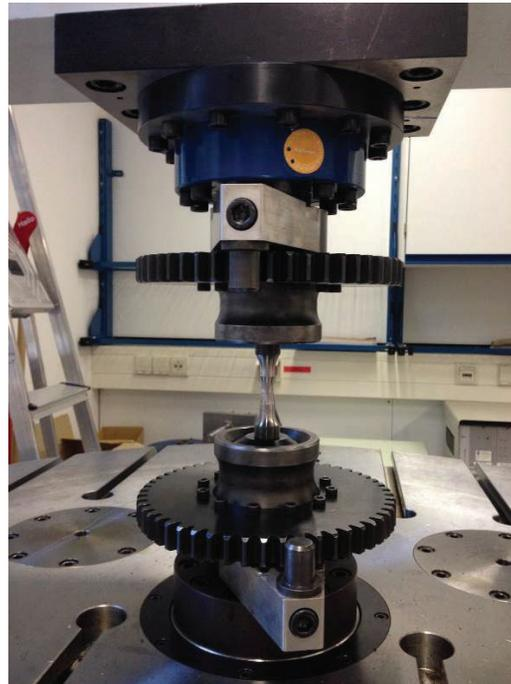
Bild 2: ADI-Wöhlerversuch am Resonanzprüfstand
