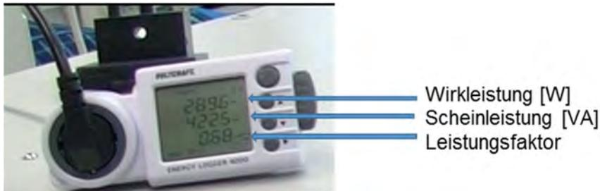
**Abbildung 63:** Messgerät
