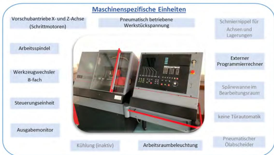
**Abbildung 67:** Komponenten der Drehmaschine EMCO 120P [51]
