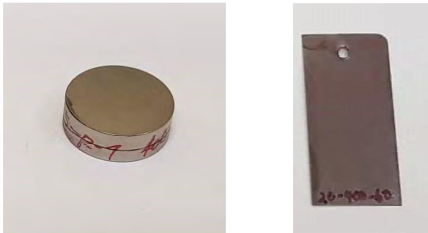
**Abbildung 42:** Probestkörper (100Cr6 Ronde und Stahlblech)
