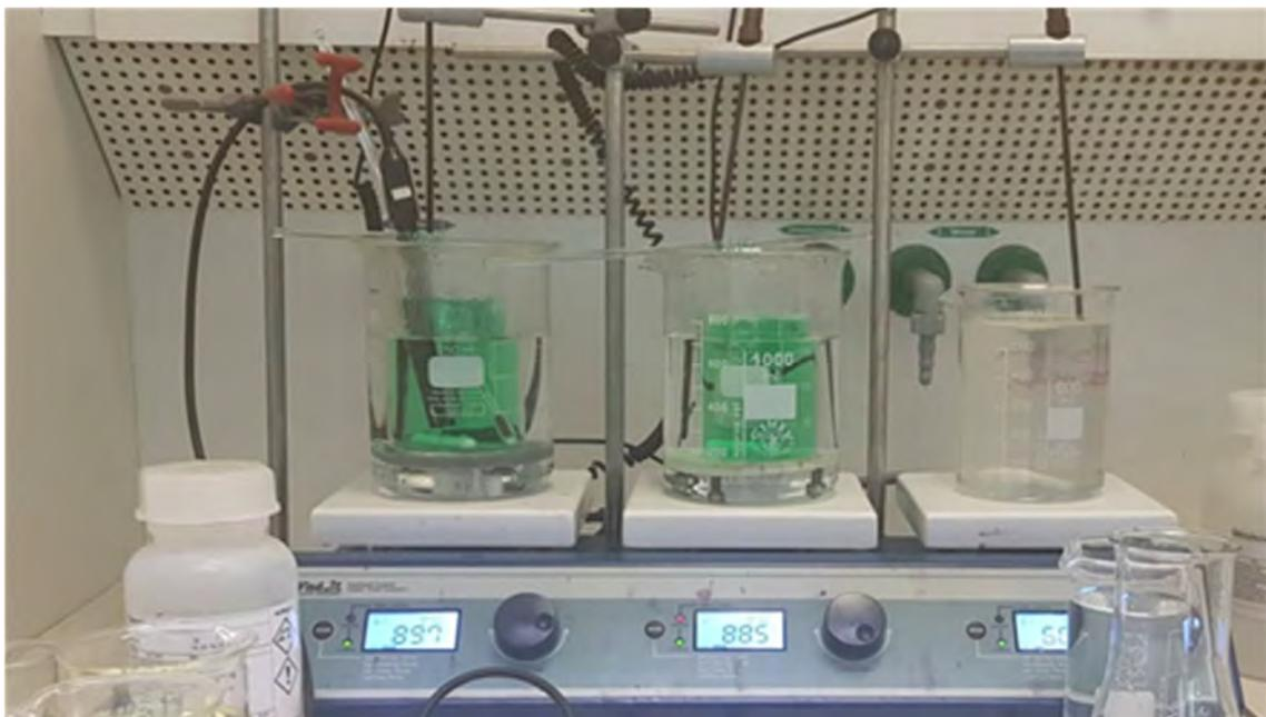
**Abbildung 43:** Versuchsaufbau chemisch Nickel Beschichtungsvorgang
