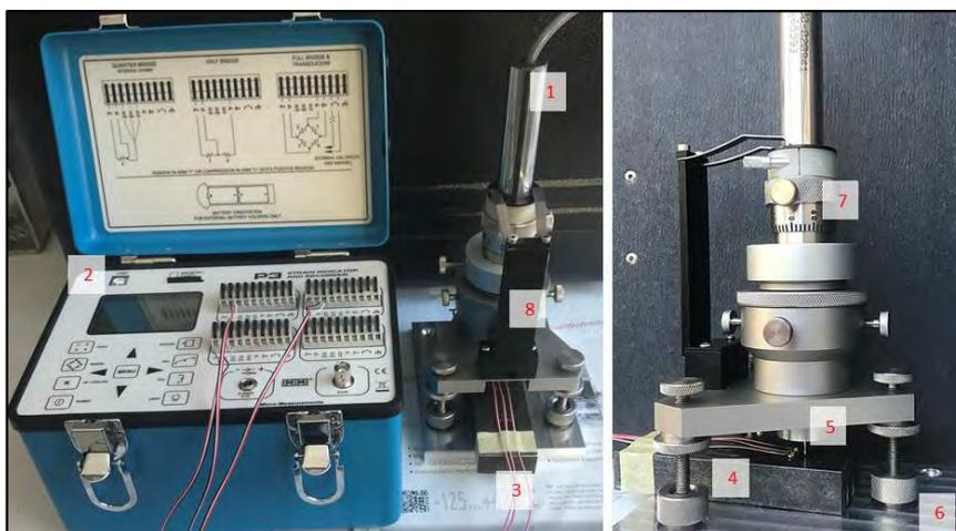
**Abbildung 24:** Versuchsaufbau der Eigenspannungsmessungen
