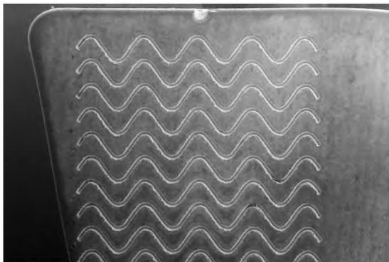
**Abbildung 29:** Wendeschneidplatte vor der Nassbearbeitung
