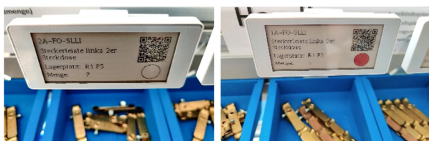
Abbildung 3: ESL für Materialbereitstellung im Ausgangszustand (li.) und ESL mit aktivem Pick-by-Vision für Auftrag (re.)
