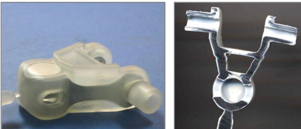
Abbildung 2: Kettenglieder mit Zinkdruckgusseinleger (links) [Roh09] sowie in Sandwichstruktur (rechts)
