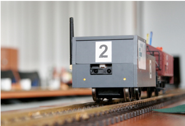
Bild 7: ATLAS-Fahrzeug mit IR-Abstandssensor und LEDs
