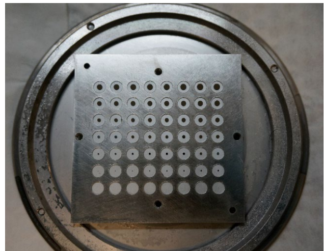
Abbildung 1: 56 Kalziumfluoridsubstrate im Beschichtungshalter mit tantalbeschichteten Maskenbereichen. Frontplatte und Tantalfolie wurden entfernt.
