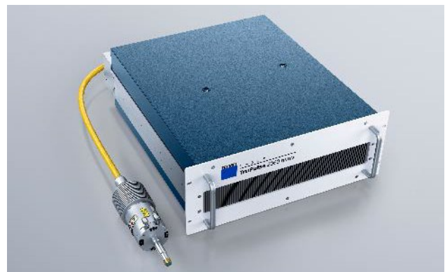
Abbildung 2: Der ns-Faserlaser TruPulse nano 2060 kann durch seine flexiblen Pulsparameter und eine mittlere Leistung von 600W sowohl qualitative Herausforderungen bewältigen als auch sehr produktiv diverse Batteriefolien schneiden.
