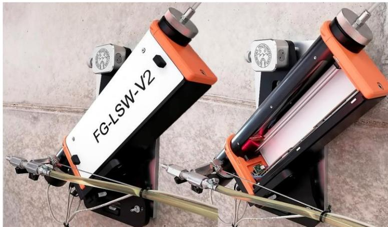
Abb. 1: Hydrostatische Laser-Präzisionsschlauchwaage (LSW) nach Kubisch, Lorenz, WEV 2023
