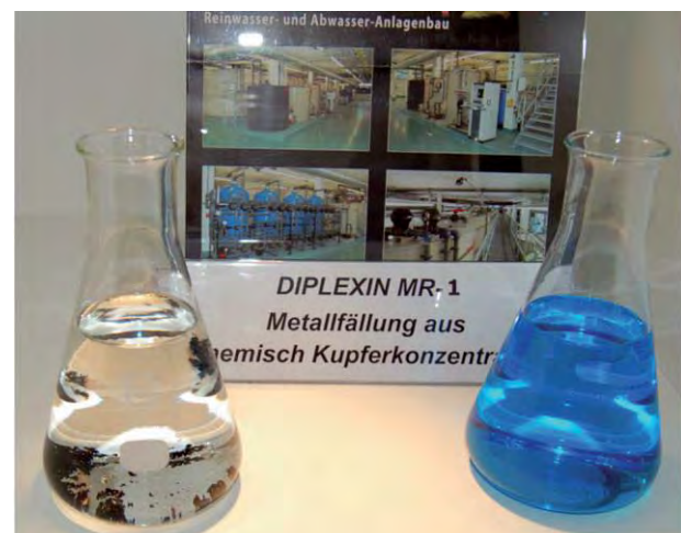
Abbildung 02: Chemisch-Kupfer Konzentrat nach dem Metall-Ex-Verfahren
