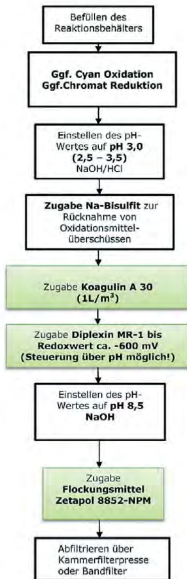
Abbildung 03: Verfahrensablauf des Metall-Ex-Verfahrens
