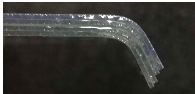
Abb. 4: Umgeformte Glaskanten an Xensation® der Fa. Schott AG
