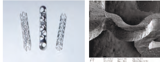
Abbildung 3: Links - Übersicht Stentgrößen und -strukturen; Mitte - REM Aufnahme Stentstruktur;
