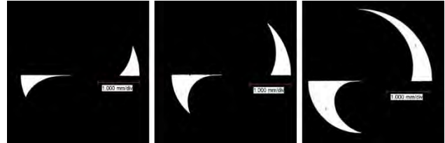
Abb. 3: Mikroskopaufnahmen der Testmasken mit einem maximalen Öffnungswinkel von 25°, 50° und 90°.
