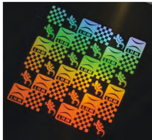
Bild 5: großflächige als Beugungsgitter wirkende sub-Mikrostrukturierung auf Edelmetall 1.4301: Größe 140 mm x 140 mm, Parameter: Wellenlänge 1064 nm, Pulsdauer 10 ps, Puls wiederholrate 20 MHz, mittlere Leistung 230 W, Fokussdurchmesser 80 \mu\text{m} , Linienabstand 12,5 \mu\text{m} , Pulsabstand 20 \mu\text{m} , 1 Überfahrt, effektive Flächenrate 633 \text{cm}^2/\text{min} .
