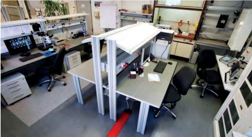
Abbildung 5: Zählerprüfstrecke des Instituts für Energiemanagement an der Hochschule Mittweida vi
