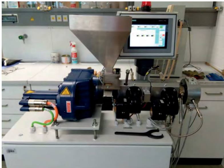
Abb. 1 - Laborextruder KEP 16-25-S, Firma Ematik (Hochschule Anhalt, AG Gottstein)
