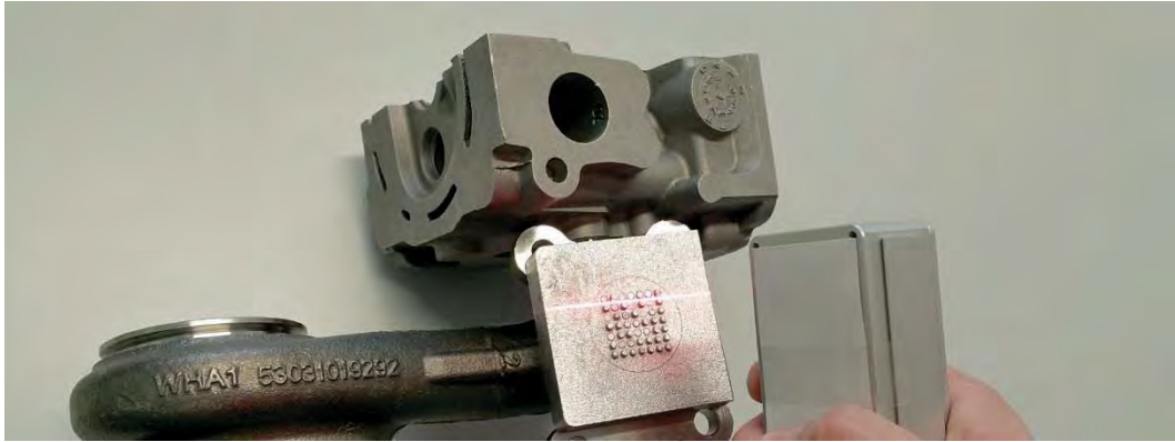
Abbildung 1: Scannen eines DataMatrix-Codes durch Lasertriangulation. © Hochschule Harz
