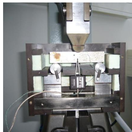
Abb. 2: offene Kühlkammer mit Thermoelement und COD-Clip
