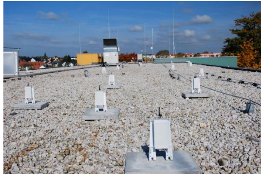
Abbildung 4: Testbed mit 30 Sensorknoten
