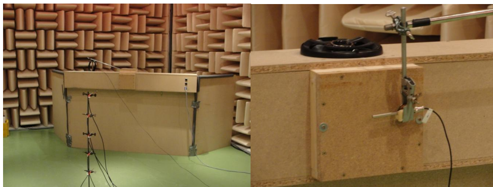
Abbildung 8: Modelllärmwand mit ANC-Aufsatz im akustischen Halbfreifeldraum der SLG.
