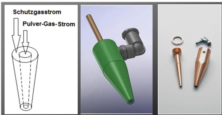
Abb. 2: Darstellung der entwickelten Lateralpulverdüse mit Schutzgasummantelung, Prinzipskizze (links), SolidWorks-Konstruktion (mitte) und gefertigten Teile (rechts)
