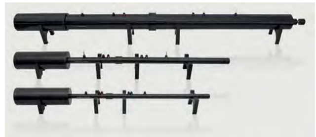
Bild 1: Transmissionsmessrohre verschiedenen Durchmessers zur messtechnischen Bestimmung der charakteristischen Absorberparameter von porösen Materialien
