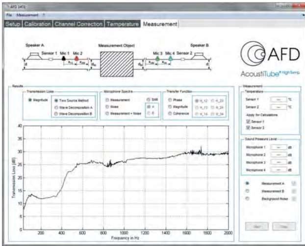
Bild 6: Bestimmung der Durchgangsdämpfung und der komplexen Übertragungsmatrix von Schalldämpfern durch Einsatz der Two-Source-Methode und der Two-Load-Methode
