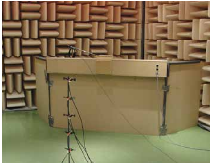
Abb. 2: Versuchsaufbau der aktiven Modelllärmschutzwand im akustischen Halbfreifeldraum
