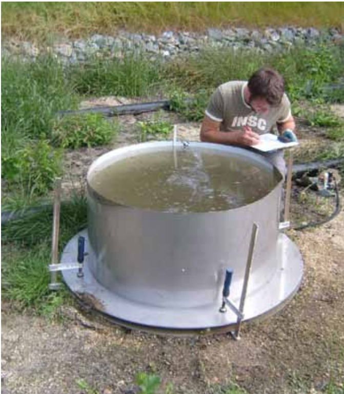
Instationäre Infiltrationsmessung mit Einfachring-Infiltrometer
