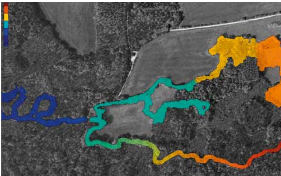
Wasserspiegellage in einer Simulation zur zeitweiligen Flutung der Leipziger Nordwestaue
