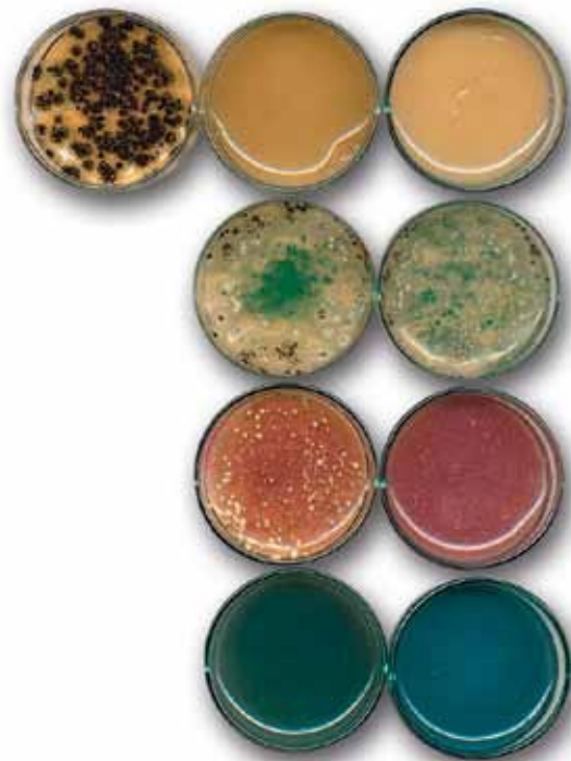
Agar-Agar-Platten ohne Hydrotalcit (links), mit 1 % Hydrotalcit (mitte) und mit 3 % Hydrotalcit (rechts)
