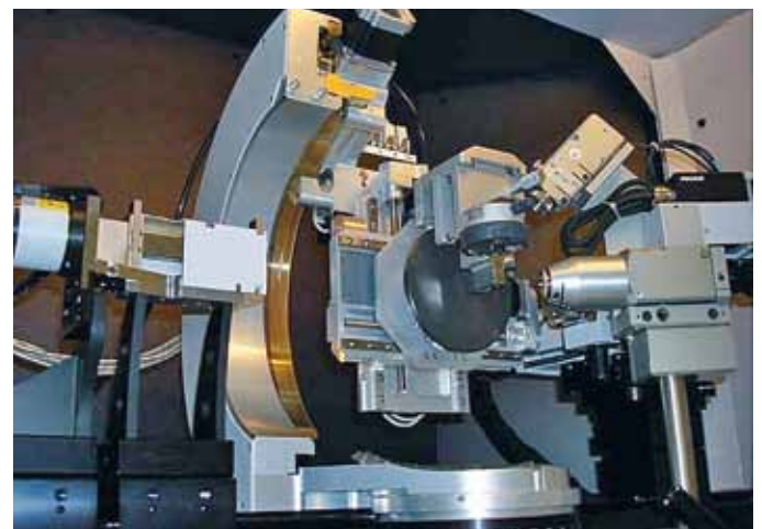
Abb. 2: Messaufbau zur Dichtemessung auf einem mit Photoresist beschichteten Wafer im Röntgendiffraktometer D8 Discover mit Flächendetektor
