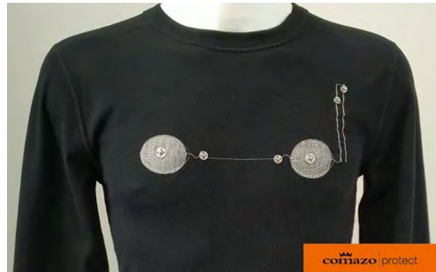
Abbildung 47: Integrierte Sensorik im Shirt
