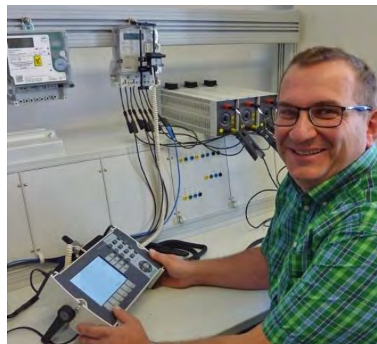
Abbildung 17: Heiko Löbel überprüft im neuen Labor des Instituts für Energie-management intelligente Stromzähler
