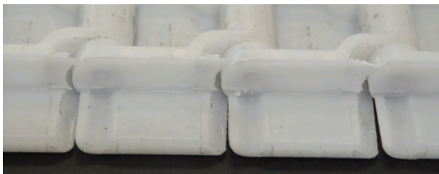
Bild 3: Aufgrund zu hoher Reibtemperaturen thermisch zerstörte Kette mit Materialabtrag sowie Materialfließen an der kurveninneren Seitenführungsfläche
