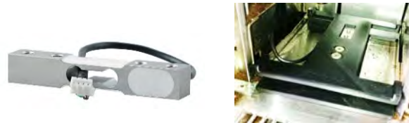
Bild 7: a) Wägezelle BW10026 [5]; b) Gedrucktes Waagekreuz in der Kaffeemaschine
