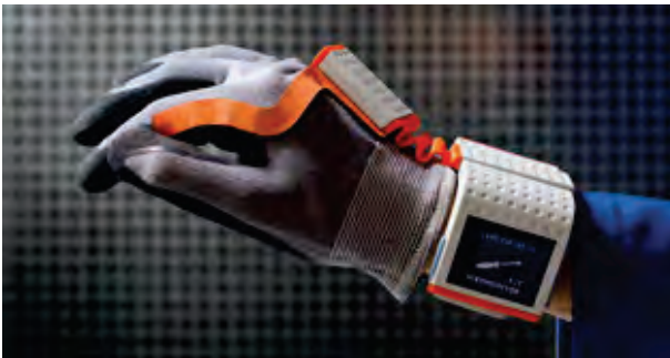
Bild 1: Industriehandschuhe mit integrierten Sensoren (Druck, Temperatur; aus [2])
