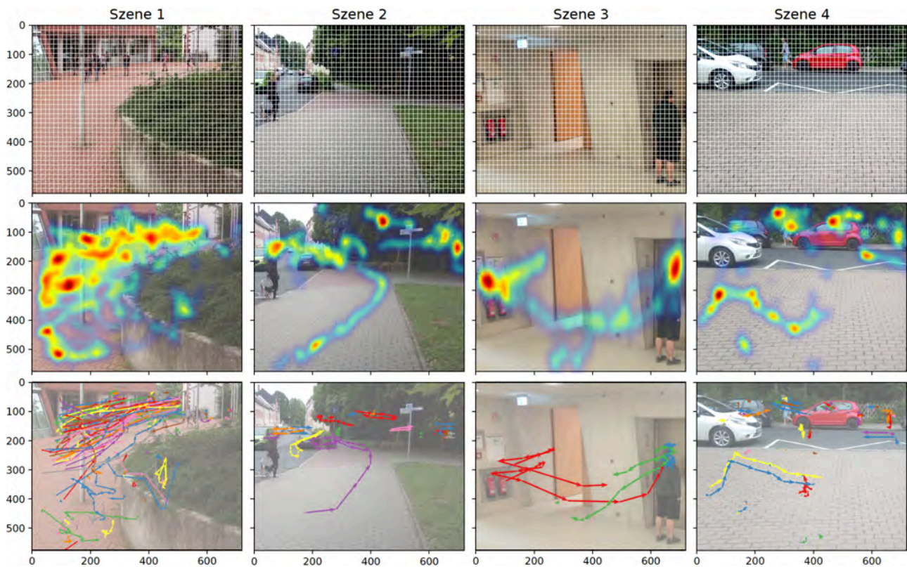
Bild 9: erste Zeile Startframes mit Rasterung für Heatmap, darunter aggregierte Darstellungen aller Bewegungen während der Laufzeit des jeweiligen Videos: Zeile 2 Bewegungs-Heatmap, Zeile 3 Bewegungs-Vektoren.
