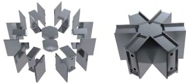
Bild 3: eine Knotenverbindung von Seele des Glas-Schalendachs in Westfield, London – Jeder Knoten besteht aus 20 von Hand zusammengesetzten, verschweißten Einzelteilen
