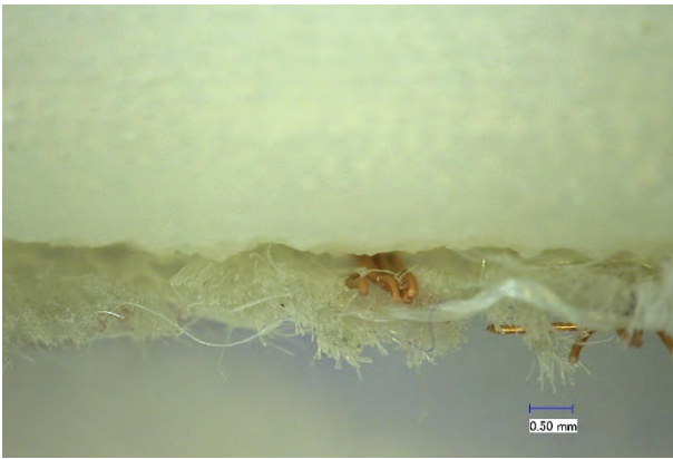
Bild 7: Stereomikroskopische Aufnahme nach Präparation des Polyester-Kupferdraht-Gewebes mit gedrucktem TPE-ET-Punkt
