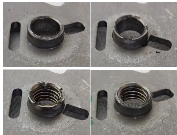
Bild 3: Mögliche Fehlerbilder bei geformten Gewinden in Tiefziehteilen
