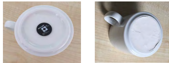
Bild 6: a) RFID Tag auf Tassenboden; b) Tassenboden aufgefüllt mit Silikon
