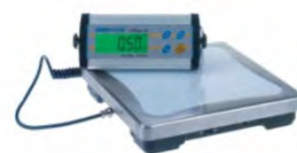
Bild 8: Industriewaage mit Anzeigeelement (Adam CPW Plus 35) [6]
