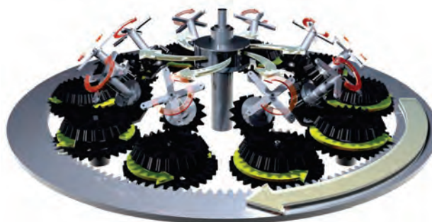
Abbildung 1: Darstellung der Schleuderrad-Strahltechnologie mit satellitenartigen Drehbewegungen der Werkstücke [2]
